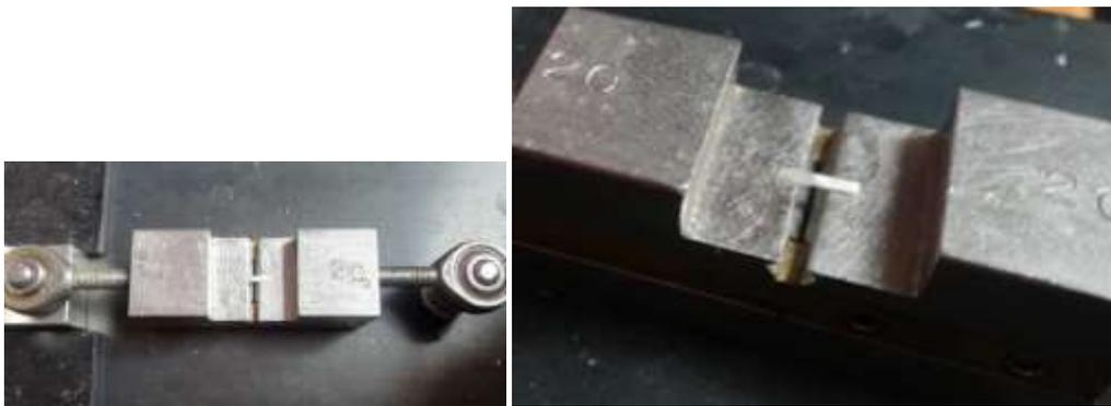
Imagen 18: Se colocaron los especímenes en las mordazas de montaje de la máquina de microtracción sobre una superficie plana y se cerraron de manera que quedaron juntas. La interfaz se ubicó sobre la unión de las mordazas.
