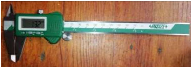
Imagen 17: Medimos el área de interfaz del espécimen con un parquímetro digital (Insize), el ancho y el grosor del espécimen, las medidas fueron anotados en la ficha de reelección datos.
