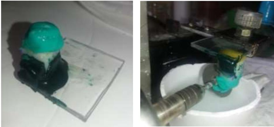
Imagen 13: Se fijó la preparación, pero ahora en una posición horizontal, se colocó la silicona fluida (Silaxil Regular Body, Enersyl) alrededor de la zona de la restauración, así evitar perder muestras al ir cortando.
