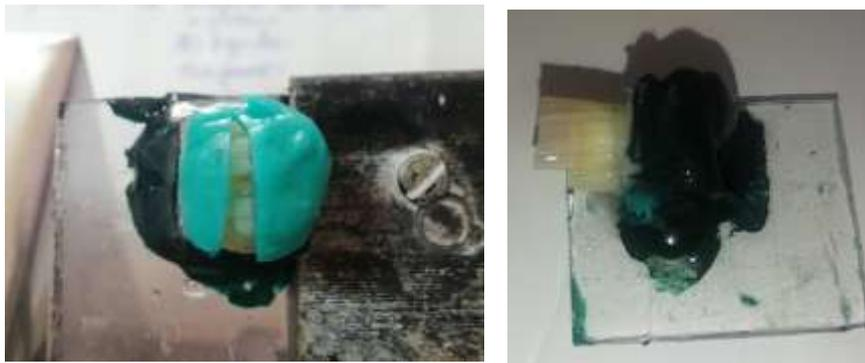
Imagen 14: Se volvió a posicionar la muestra, el corte fue al nivel de la terminación de los cortes verticales y horizontales, se retiró todo de la máquina de corte. Esto se realizó para cada muestra, de acuerdo con los dos grupos de estudio.
