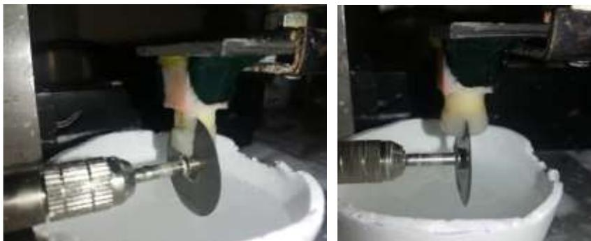
Imagen 12: En la máquina de corte, se ubicó la preparación, en una posición vertical, también se fijó con godiva, en la platina de acetato, se colocó en la máquina de corte, al ir cortando, se fue aumentando 1mm.
