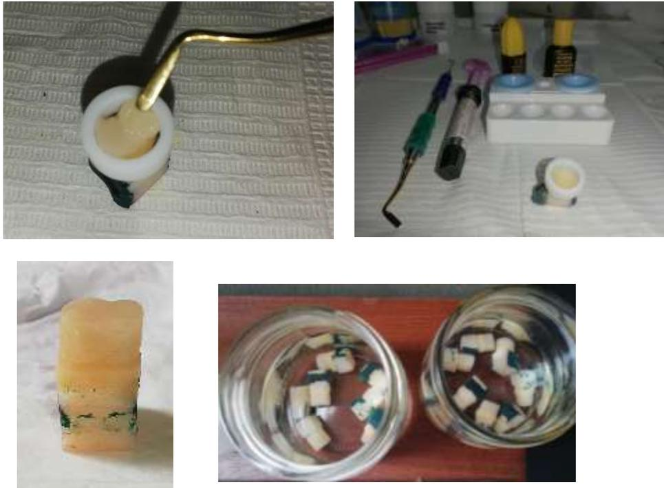
Imagen 11: Se colocó la resina compuesta (Palfique LX5 A2) con una matriz de teflón circular de 4mm de ancho por 10 mm de diámetro, por cada incremento de resina, se polimerizará con una lámpara (iLed 2500w, DTE), se realizó para cada preparación y se dejó por 24 horas en agua destilada, para conservar la hidratación de las piezas dentales, de acuerdo con la preparación estuvieron separados por grupos, en un recipiente herméticamente cerrado, a temperatura ambiente.
