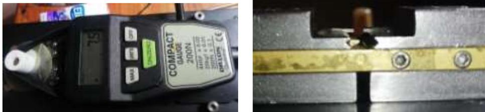
Imagen 20: Prendemos el equipo, esperamos hasta que termine de procesar datos después presionamos el botón Star/Test, el valor lo va a ir dando la máquina de Microtracción, según va subiendo los valores, esperamos que nos dé el valor en newton, la maquina nos avisa, una vez que indicado el valor y separación de la interfaz, le damos al botón Reset/Reverse.
