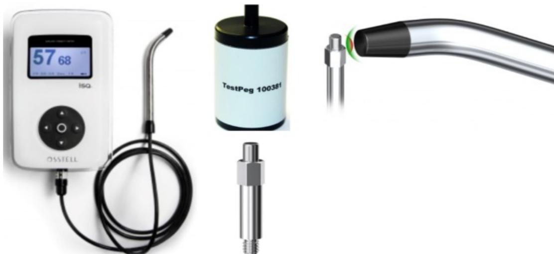
**Figura 29:** Sistema de análisis de frecuencia de resonancia.
