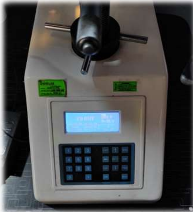
Figura 7. Medición de la microdureza con el Microdurómetro LG (HV-1000).
