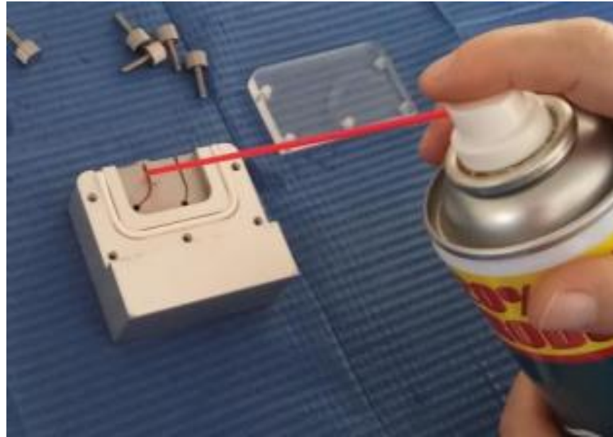
Figura 9: Lubricación del conducto de acero antes de la utilización de cada lima.
