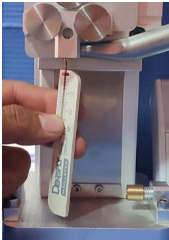
Figura 7: Con una regla milimetrada se realizó la medición de las limas a 16 mm. antes de la prueba.
