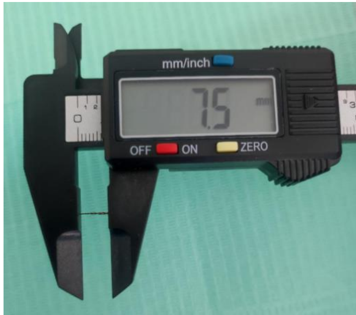
Figura 12: Medición de fragmento fracturado con calibrador digital
