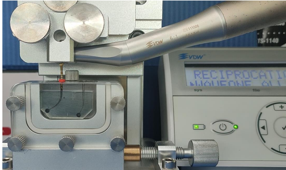
Figura 8: Prueba de fatiga cíclica en dispositivo de acero con el movimiento alternativo wave one all que indica el motor.
