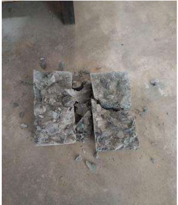
Imagen 92 – Resultado de la Probeta patrón N°01 – 07 días. / Imagen 93 – Probeta.
