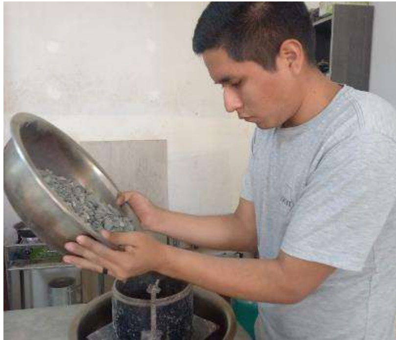
Imagen 10 – Proceso para la obtención de la densidad mínima y máxima de la piedra, se realizó 3 veces.
