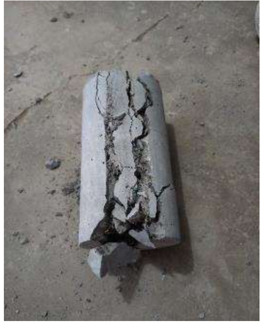
Imagen 124 – Resultado de la Probeta con 0.3% de nylon N°08 – 14 días. / Imagen 125 – Probeta.
