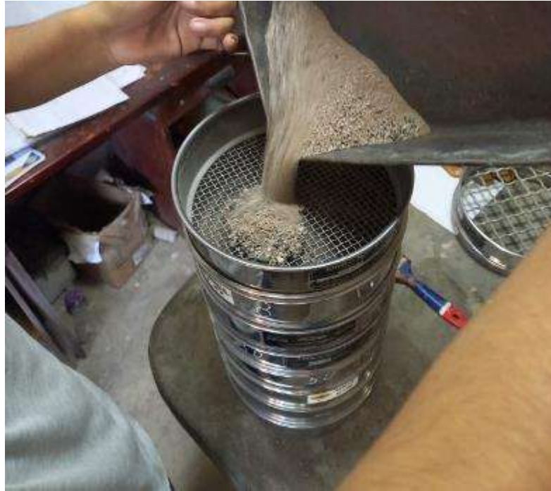
Imagen 8 – Tamizado de los agregados, se utilizó los tamices N° 1, 3/4, 1/2, 3/8, 4, 8, 16, 30, 50, 100 y 200, más una bandeja.
