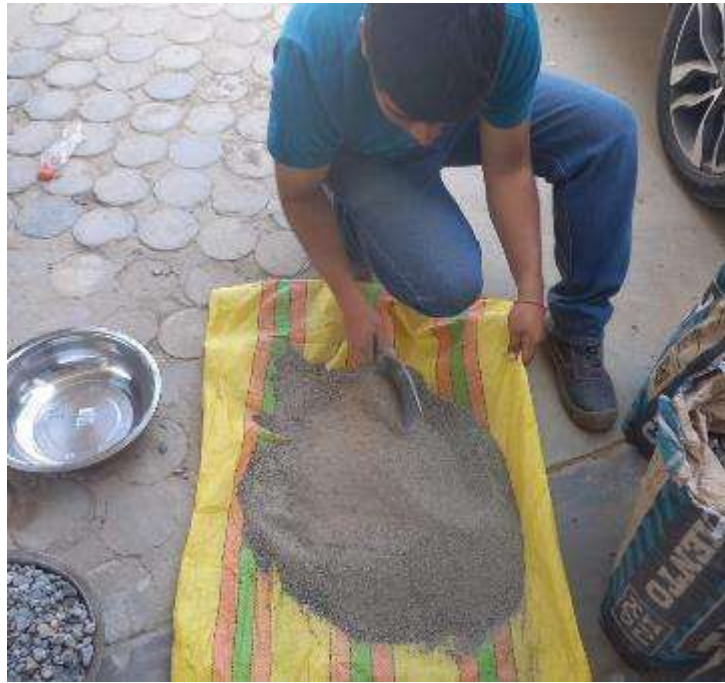
Imagen 4 – Homogenización de los agregados dividida en 4 y se escoge los lados opuestos.
