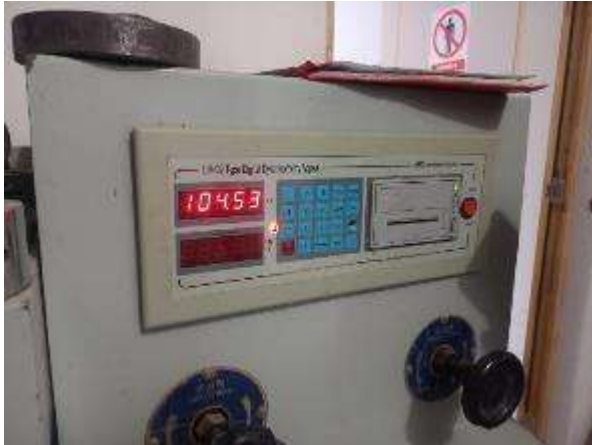
Imagen 136 – Resultado de la Probeta con 0.2% de nylon N°05 – 28 días. / Imagen 137 – Probeta.
