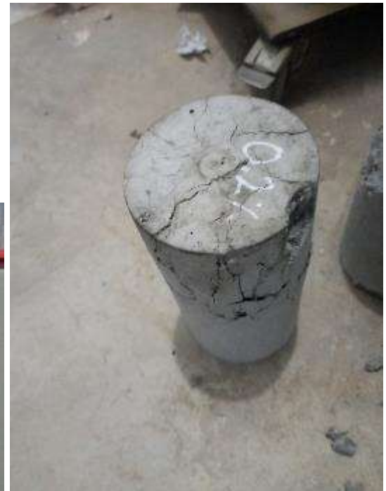
Imagen 26 – Resultado de la Probeta con 0.2% de nylon N°04 – 07 días. / Imagen 27 – Probeta.
