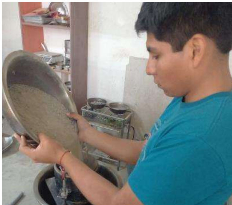
Imagen 11 – Proceso para la obtención de la densidad mínima y máxima de la arena, se realizó 3 veces.
