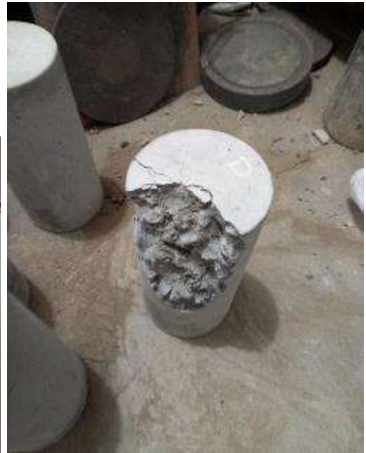
Imagen 68 – Resultado de la Probeta Patrón N°01 – 28 días. / Imagen 69 – Probeta.
