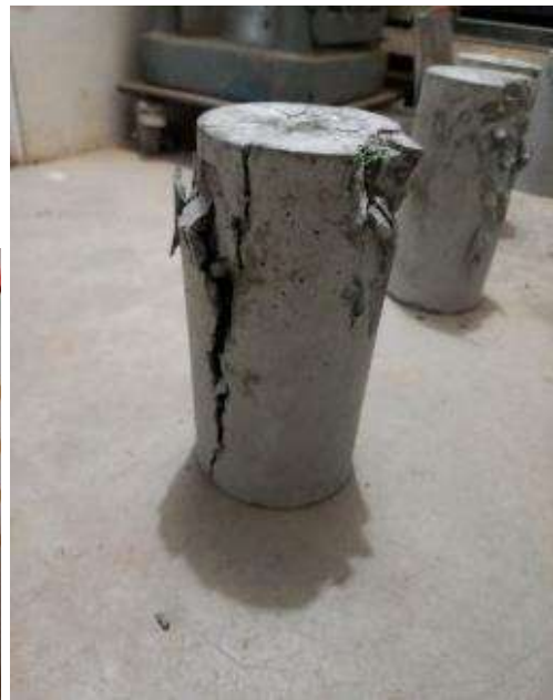
Imagen 66 – Resultado de la Probeta con 0.5% de nylon N°12 – 14 días. / Imagen 67 – Probeta.
