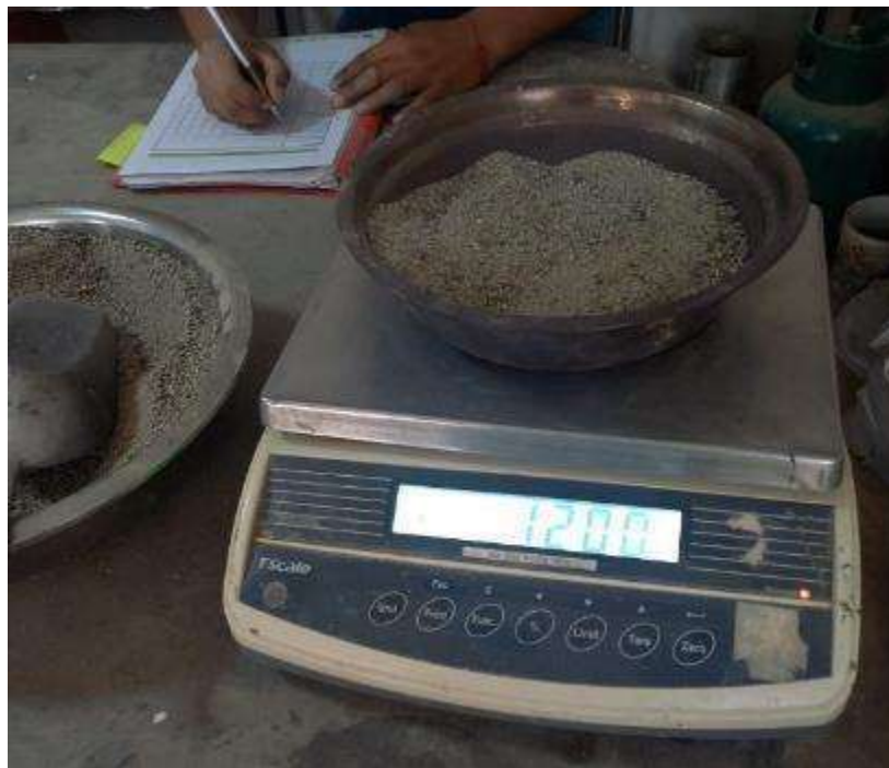
Imagen 5 – Pesaje de 1200g de bandeja + arena.
