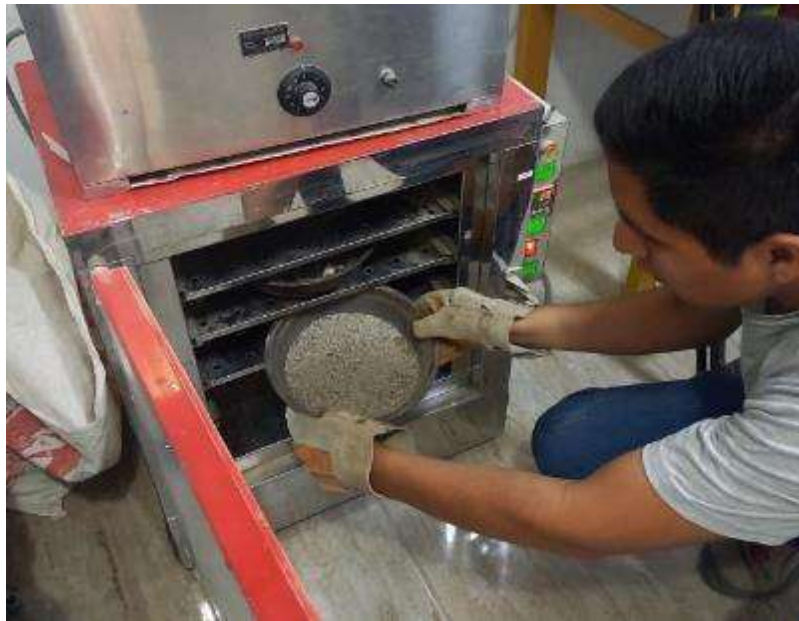
Imagen 7 – Retiro de las bandejas con los agregados del horno.
