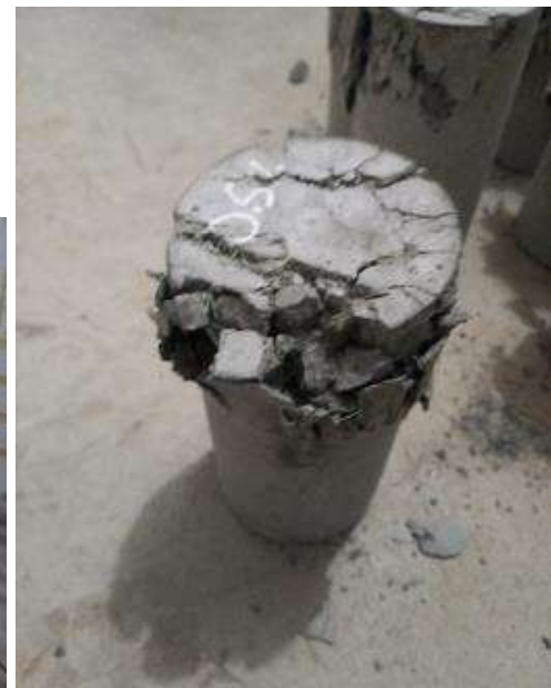
Imagen 42 – Resultado de la Probeta con 0.5% de nylon N°12 – 07 días. / Imagen 43 – Probeta.
