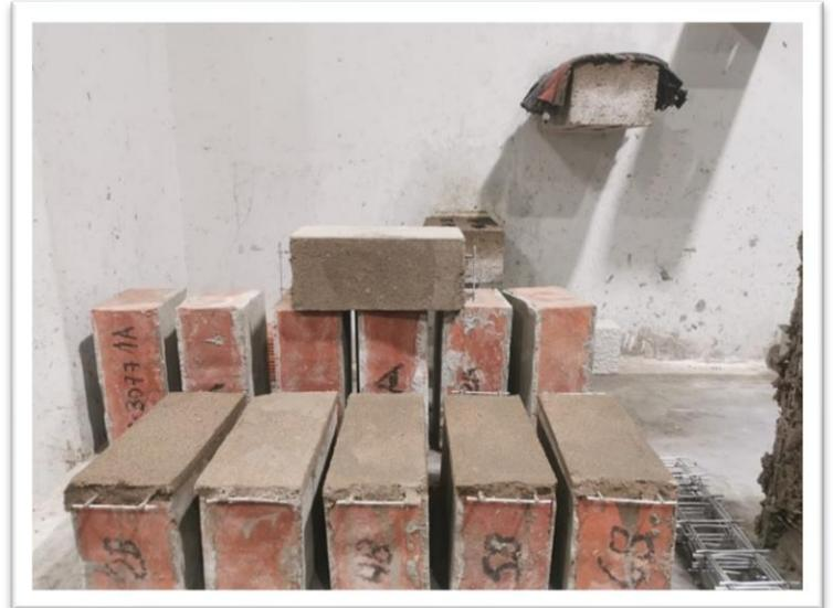
Foto N°01: Se realizó el corte de la malla y fabricadas para la colocación de los ladrillos de King Kong de albañilería de 12cm de ancho y largo 22.5cm, también se tarrajearon las 2 caras de los ladrillos, como se ve en la imagen son 6 ladrillos con mallas electrosoldadas y 6 sin mallas electrosoldada, (Se dejó curando por 14 días)
