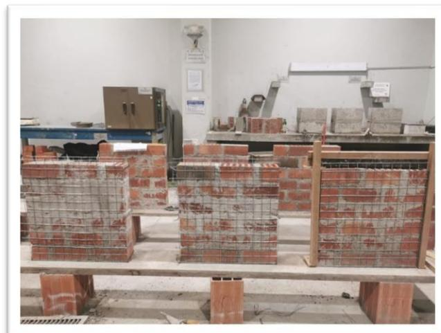
Foto N°03: Se realizo el corte de la malla y fabricadas para la colocación de los ladrillos de King Kong de albañilería (MURETES DE ALBAÑILERIA) de 63.8cm de ancho y 60.3 cm de largo, también se tarrajearon las 2 caras de los ladrillos, como se ve en la imagen son 3 muretes con mallas electrosoldadas y 3 muretes sin mallas electrosoldada, (Se dejo curando por 14 días).
