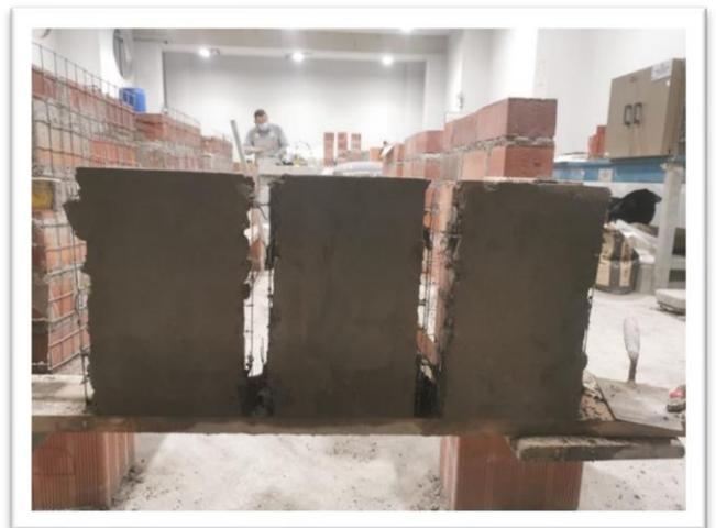
Foto N°02: Se realizó el corte de la malla y fabricadas para la colocación de los ladrillos de King Kong de albañilería (PILAS DE UNIDAD DE ALBAÑILERIA) de 12cm de ancho, y 40.6 cm de alto, también se tarrajearon las 2 caras de los ladrillos, como se ve en la
