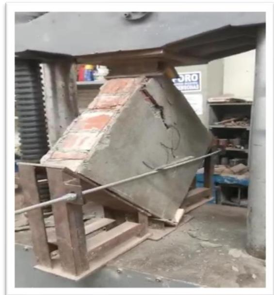
Foto N°06: Como se ve en la imagen el antes y después del ensayo en laboratorio de murete de albañilería de 63.8cm de ancho y 60.3 cm de largo con mallas electrosoldadas, se realizaron los ensayos con mallas electrosoldadas y sin mallas electrosoldadas.
