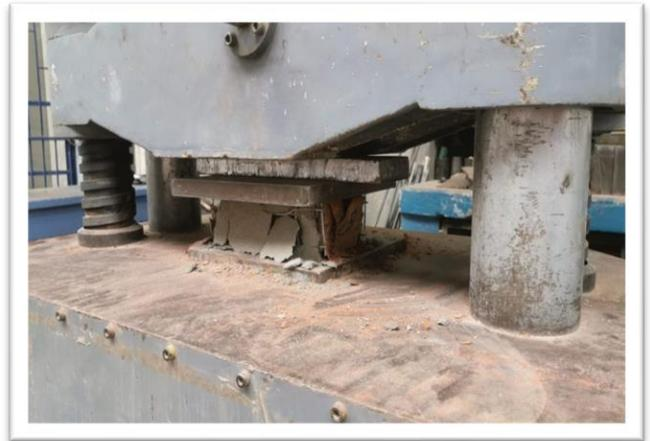
Foto N°05: Como se ve en la imagen un antes y después del ensayo en el laboratorio de ladrillo King Kong de albañilería de 12cm de ancho y largo 22.5cm, se realizaron los ensayos con mallas electrosoldadas y sin mallas electrosoldadas.
