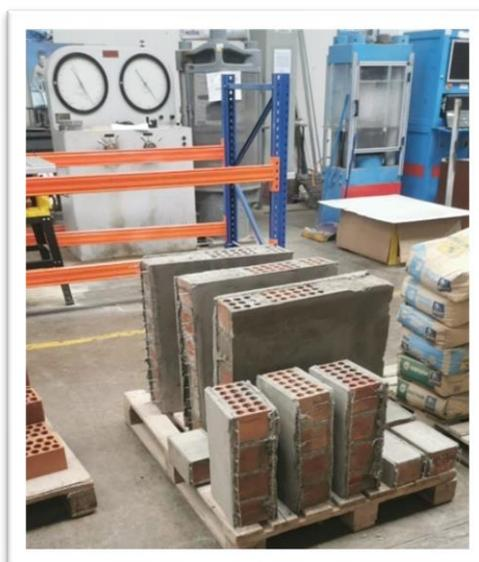
Foto N°04: Como se ve en la imagen ya se tiene terminado de asentado de ladrillo, tarrajado y instalado las mallas electrosoldadas, se tiene listo para los ensayos correspondientes.
