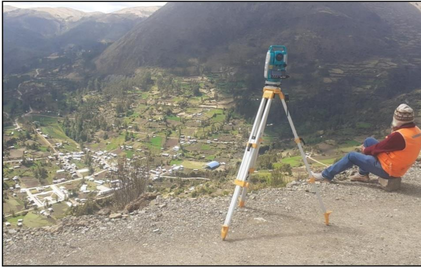
En la imagen se observa al personal técnico y el equipo (estación total) para el correspondiente levantamiento topográfico de la localidad de Muñapucro.
