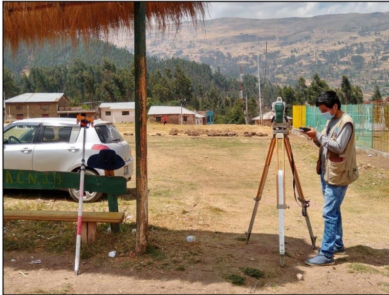
En la imagen se observa al personal técnico y el equipo (estación total) para el correspondiente levantamiento topográfico de la localidad de Quispimarca.
