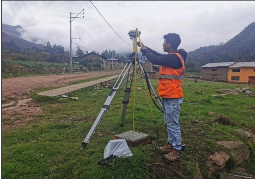
En la imagen se observa al personal técnico realizando el trabajo de medición del punto geodésico de control de orden "C".
