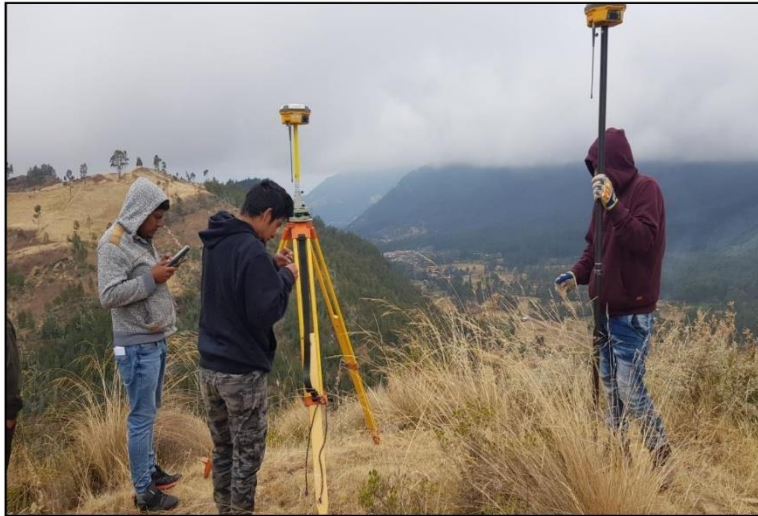
En la imagen se observa la cuadrilla de levantamiento topográfico estacionando la base del GPS diferencial, en el sector de buena vista.
