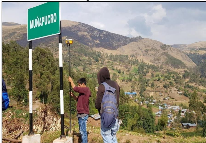
En la imagen se observa al personal de topografía, realizando los trabajos de levantamiento de puntos de la localidad de Muñapucro.
