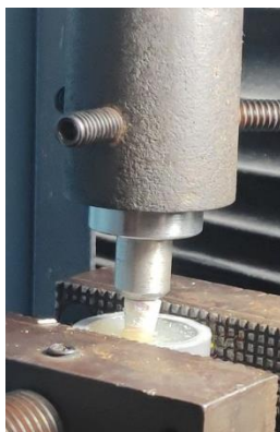
13. Prueba de compresión en máquina de ensayo universal
