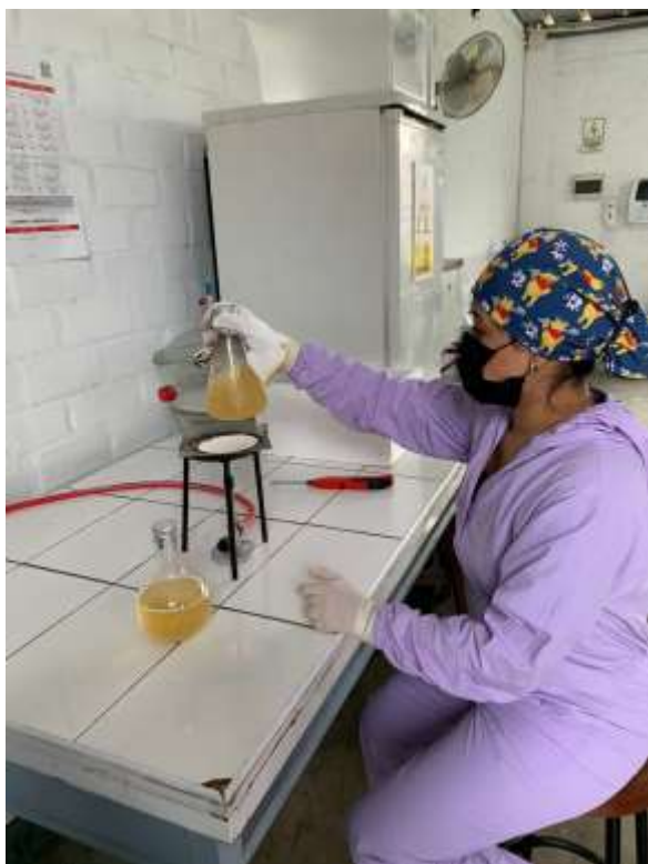
Fotografía 3. Homogenización del medio sobre el mechero y colocación en autoclave
