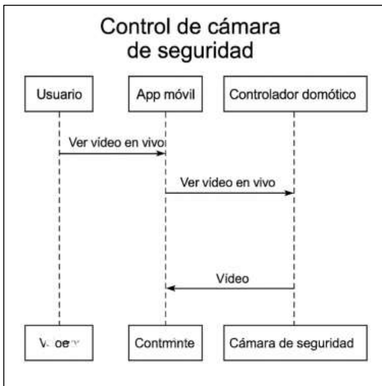
Diagrama de caso de secuencia: Control de cámara de seguridad
