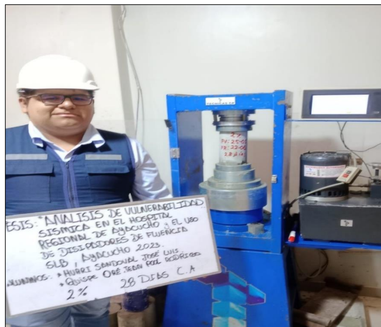
Foto 56. Ensayo de resistencia a la compresión de las probetas de concreto con adición de 2% de conchas de abanico a los 28 días de edad.
