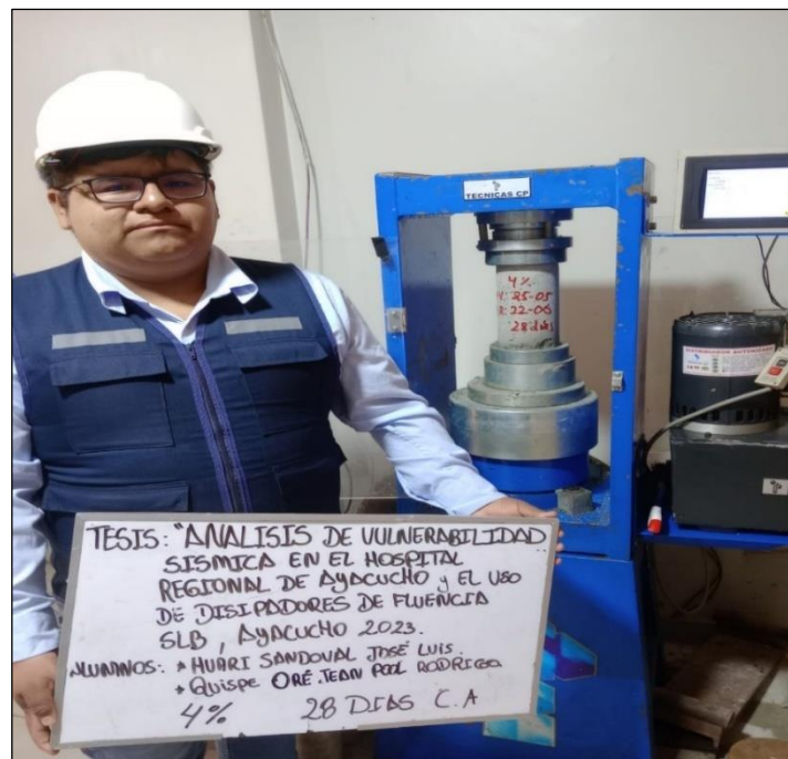
Foto 58. Ensayo de resistencia a la compresión de las probetas de concreto con adición de 4% de conchas de abanico a los 28 días de edad.
