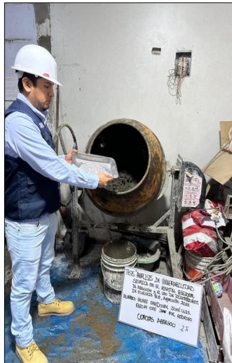
Foto 36. Adición de 2% de conchas de abanico en la mezcla de concreto.
