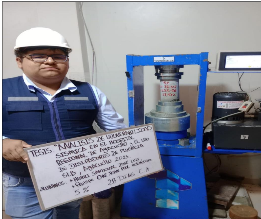
Foto 59. Ensayo de resistencia a la compresión de las probetas de concreto con adición de 5% de conchas de abanico a los 28 días de edad.
