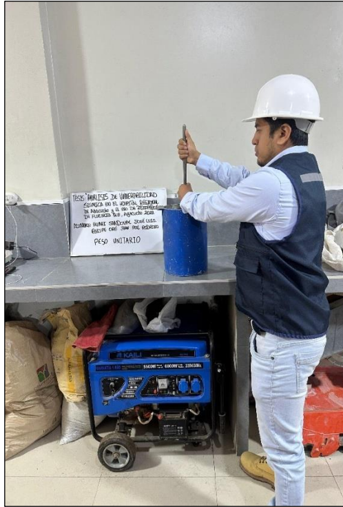
Foto 23. Varillado del agregado grueso.
