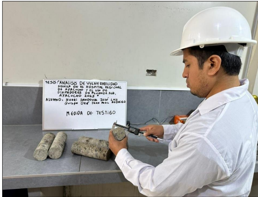
Foto 9. Medición del diámetro del testigo.
