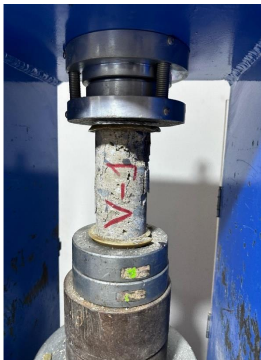
Foto 18. Rotura de testigo de viga.
