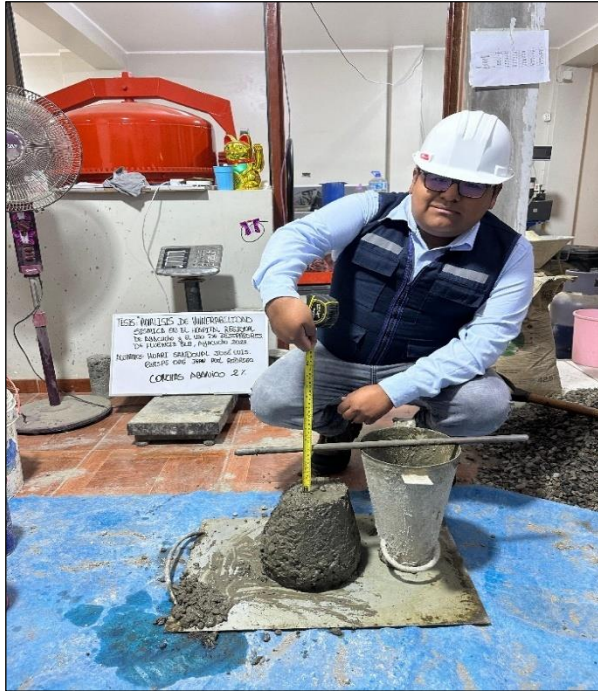
Foto 31. Slump del concreto con 2% de conchas de abanico
