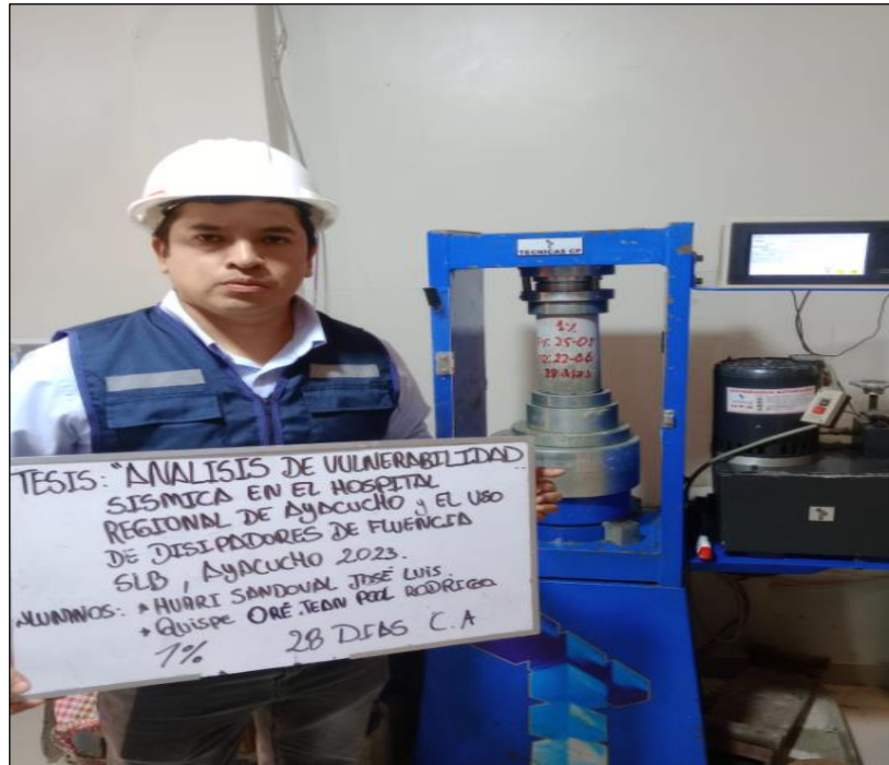
Foto 55. Ensayo de resistencia a la compresión de las probetas de concreto con adición de 1% de conchas de abanico a los 28 días de edad.
