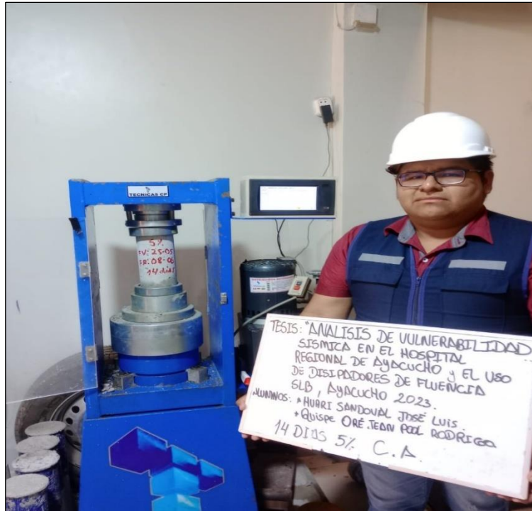
Foto 53. Ensayo de resistencia a la compresión de las probetas de concreto con adición de 5% de conchas de abanico a los 14 días de edad.
