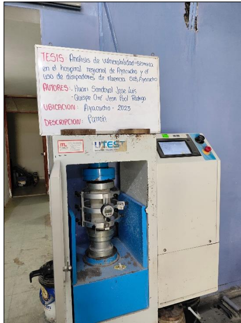
Foto 61. Ensayo de módulo de elasticidad del concreto patrón a los 28 días de edad.
