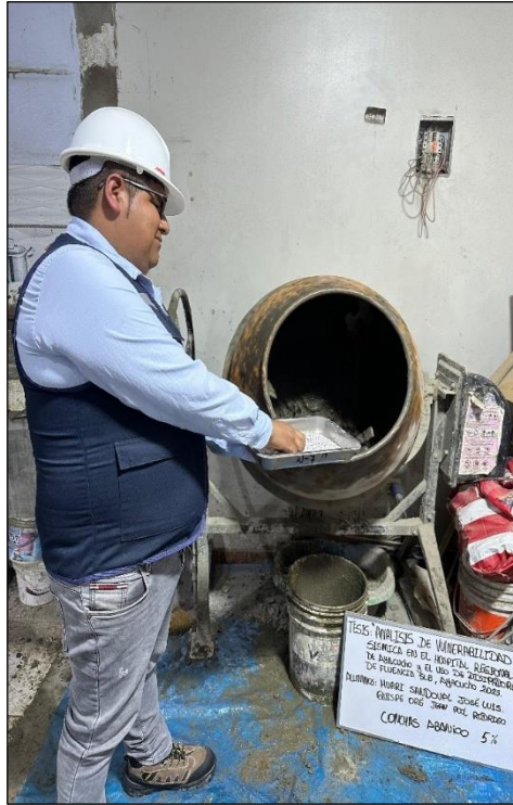
Foto 39. Adición de 5% de conchas de abanico en la mezcla de concreto.
