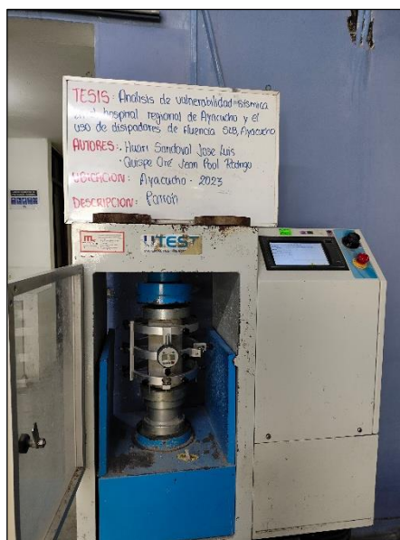
Foto 60. Ensayo de módulo de elasticidad del concreto patrón a los 28 días de edad.
