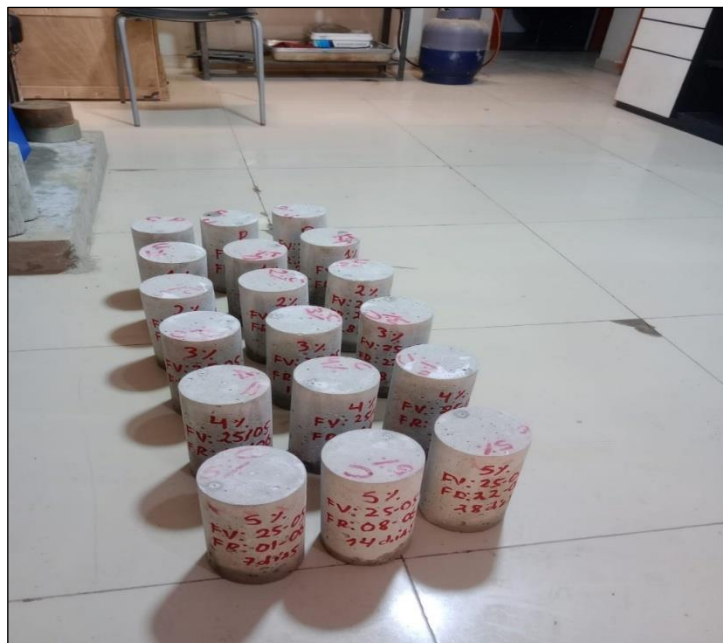
Foto 42. Probetas de concreto con diferentes adiciones de conchas de abanico para ser ensayadas a resistencia a la compresión.
