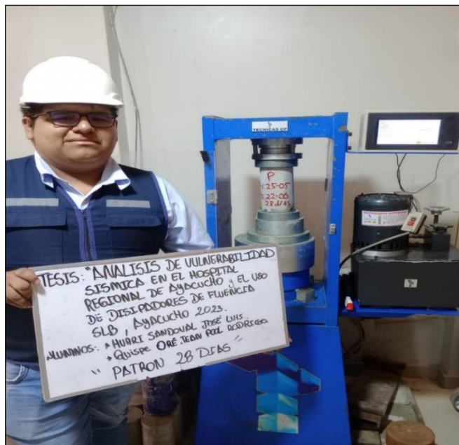
Foto 54. Ensayo de resistencia a la compresión de las probetas de concreto patrón a los 28 días de edad.
