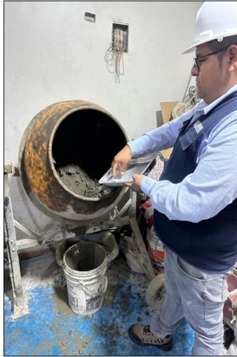
Foto 35. Adición de 1% de conchas de abanico en la mezcla de concreto.
