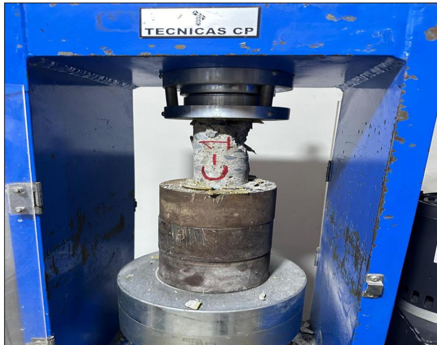
Foto 15. Rotura del testigo extraído de columna.
