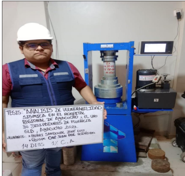
Foto 49. Ensayo de resistencia a la compresión de las probetas de concreto con adición de 1% de conchas de abanico a los 14 días de edad.
