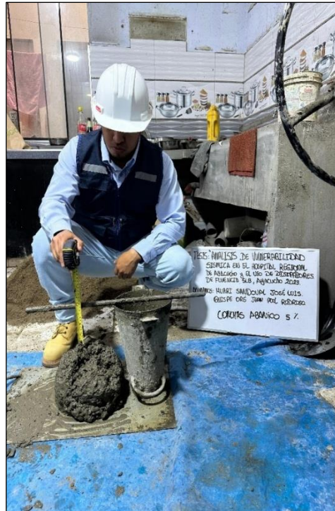
Foto 33. Slump con el 5% de conchas de abanico.
