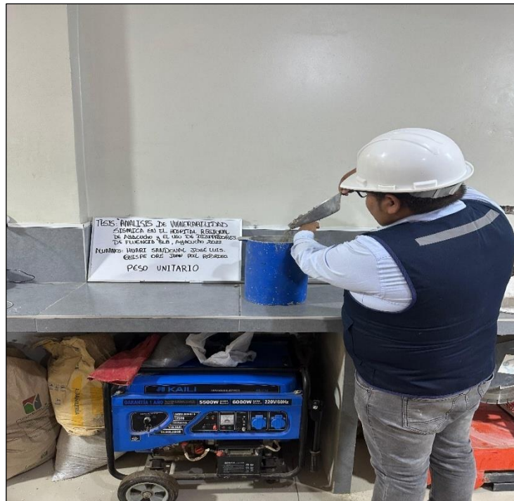
Foto 22. Determinación del peso seco compactado del agregado grueso.
