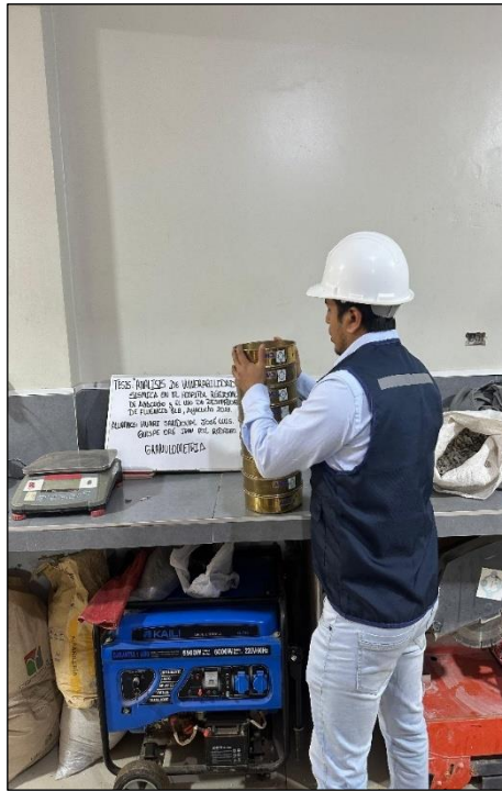
Foto 21. Proceso de tamizado de agregados para diseño de mezcla.
