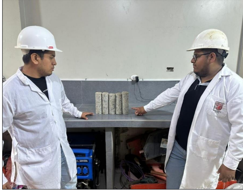
Foto 5. Testigos extraídos de para evaluar su resistencia a la compresión.
