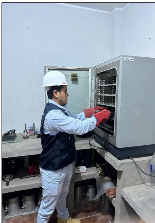
Foto 29. Contenido de humedad del agregado grueso.
