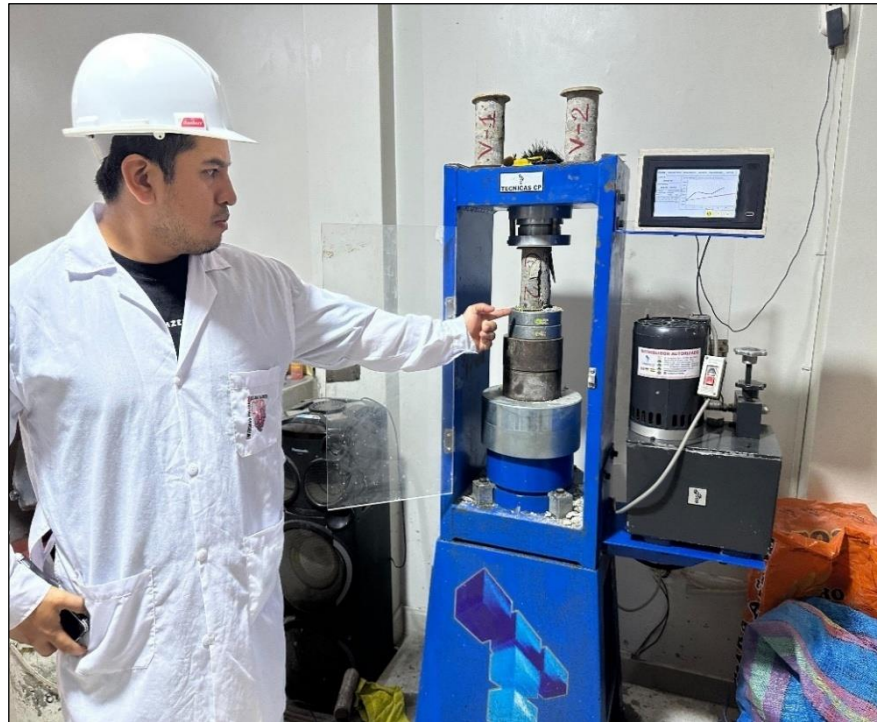
Foto 17. Rotura de testigos de viga.
