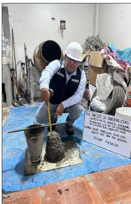
Foto 30. Slump del concreto patrón.
