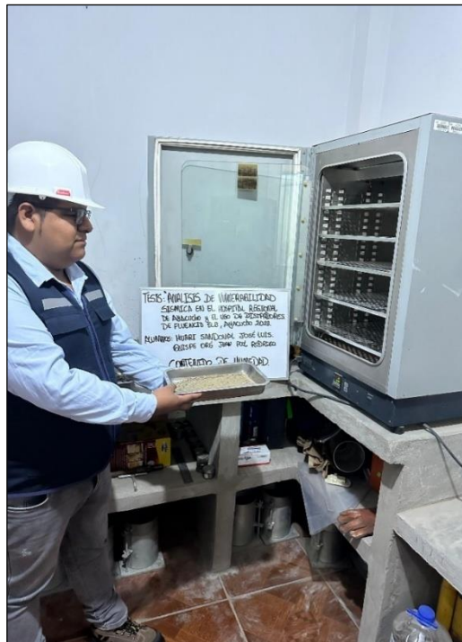
Foto 28. Contenido de humedad del agregado fino.
