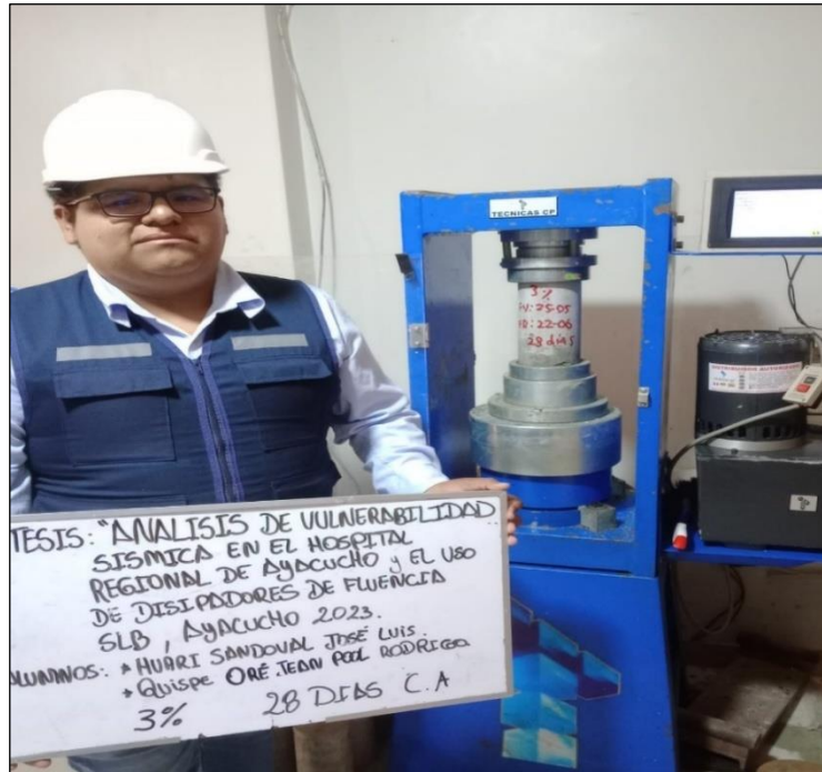
Foto 57. Ensayo de resistencia a la compresión de las probetas de concreto con adición de 3% de conchas de abanico a los 28 días de edad.
