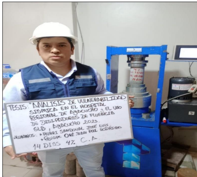
Foto 52. Ensayo de resistencia a la compresión de las probetas de concreto con adición de 4 % de conchas de abanico a los 14 días de edad.
