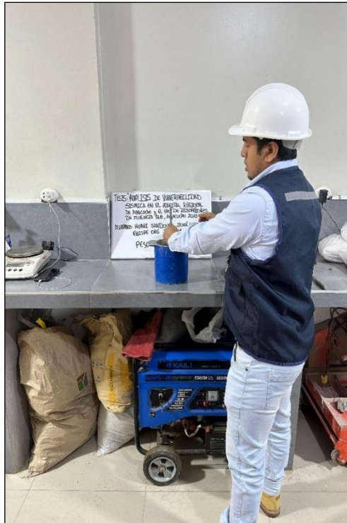
Foto 25. Varillado del agregado fino.
