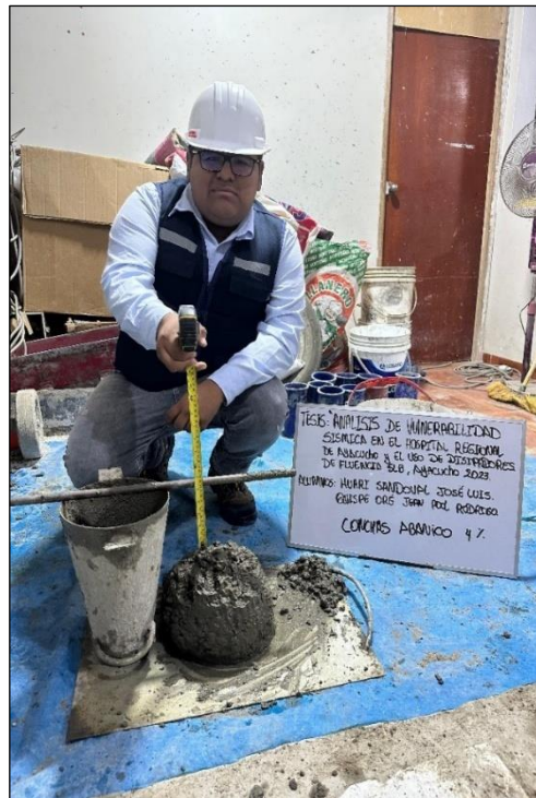
Foto 32. Slump con el 4% de conchas de abanico.
