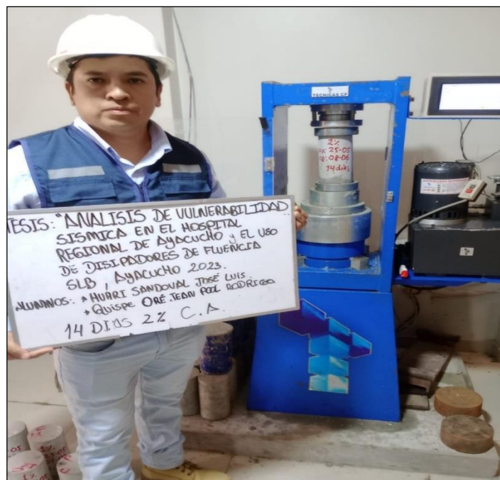
Foto 50. Ensayo de resistencia a la compresión de las probetas de concreto con adición de 2% de conchas de abanico a los 14 días de edad.
