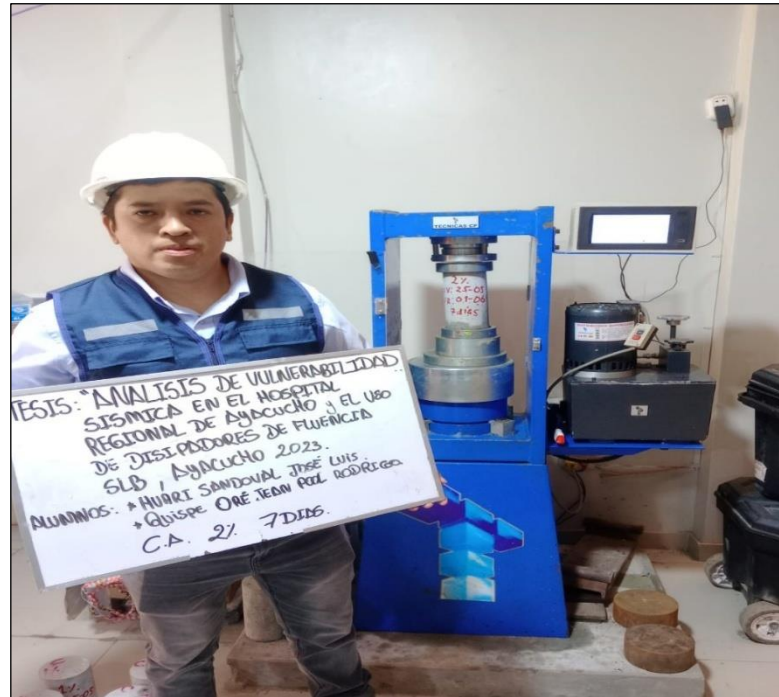
Foto 45. Ensayo de resistencia a la compresión de las probetas de concreto con adición de 2% de conchas de abanico a los 7 días de edad.
