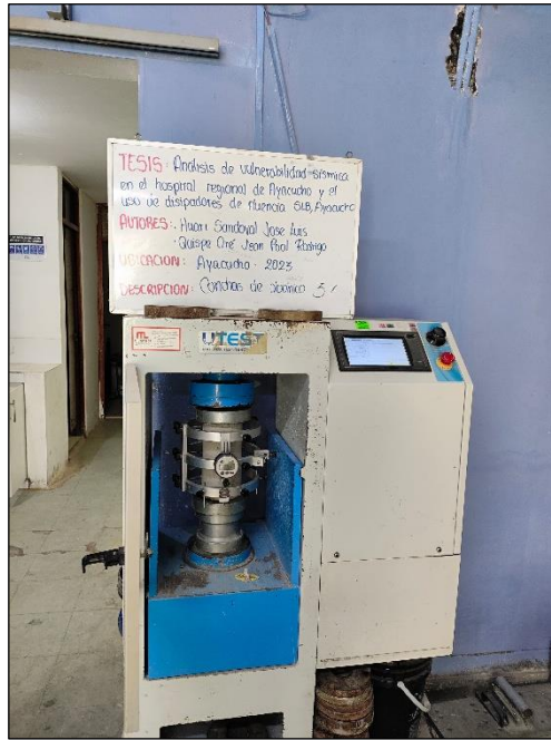
Foto 63. Ensayo de módulo de elasticidad del concreto con adición de 3% de conchas de abanico a los 28 días de edad.
