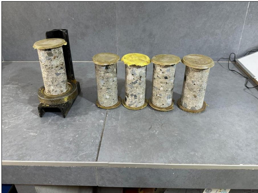
Foto 12. Realización de Capeo de muestra.
