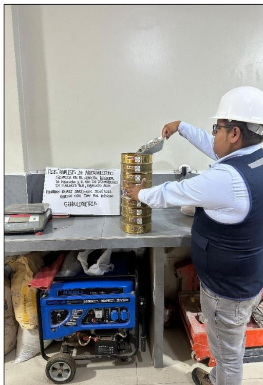
Foto 20. Tamizado de agregados para el diseño de mezcla.
