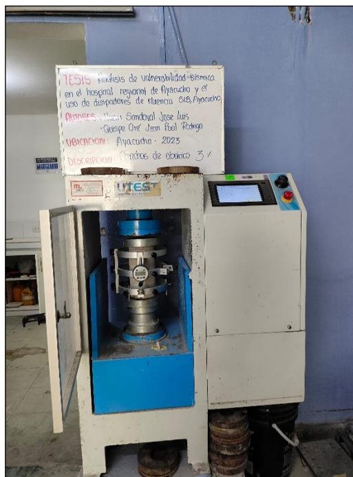
Foto 62. Ensayo de módulo de elasticidad del concreto con adición de 3% de conchas de abanico a los 28 días de edad.
