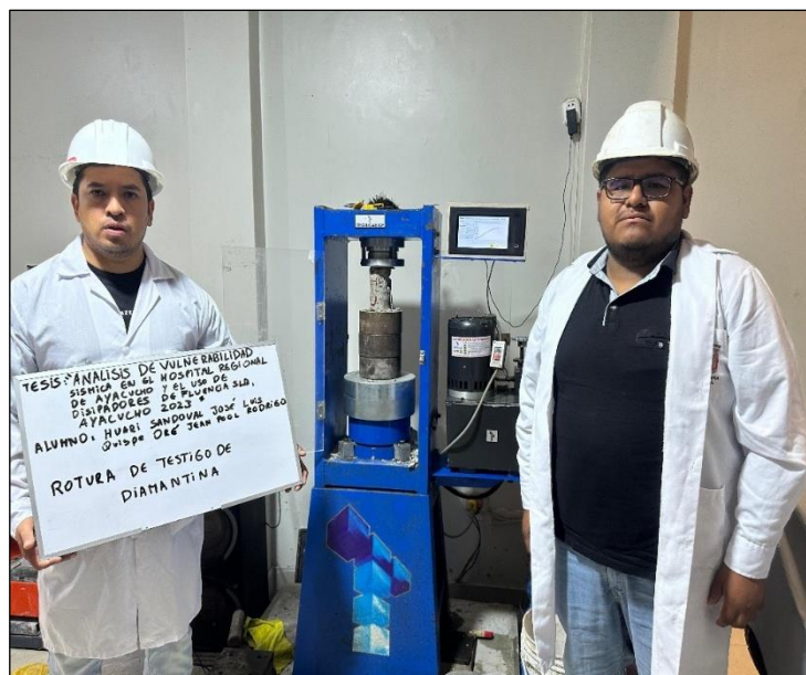
Foto 16. Determinación la resistencia a compresión de testigos extraídos de columna.
