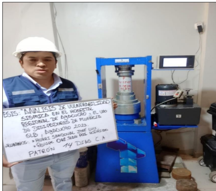
Foto 48. Ensayo de resistencia a la compresión de las probetas de concreto patrón a los 14 días de edad.
