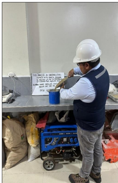
Foto 24. Determinación del peso seco compactado del agregado fino.
