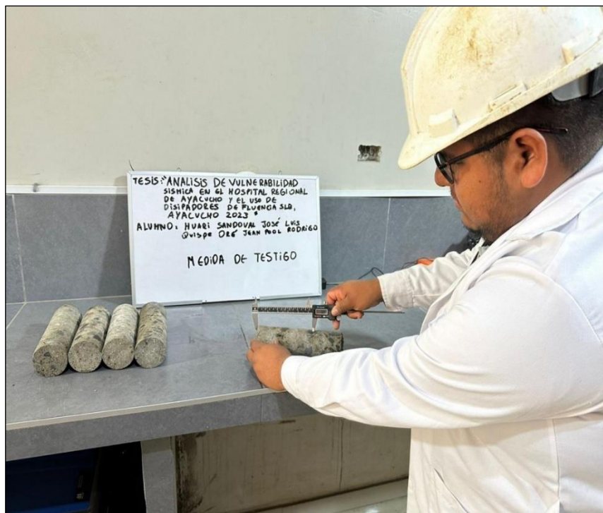
Foto 6. Medición de la altura de testigos.
