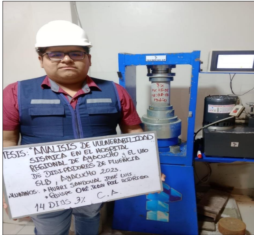
Foto 51. Ensayo de resistencia a la compresión de las probetas de concreto con adición de 3% de conchas de abanico a los 14 días de edad.
