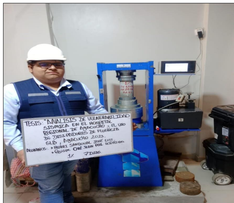
Foto 44. Ensayo de resistencia a la compresión de las probetas de concreto con adición de 1% de conchas de abanico a los 7 días de edad.
