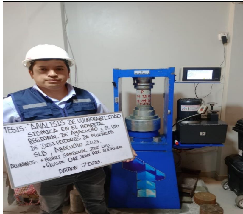
Foto 43. Ensayo de resistencia a la compresión de las probetas de concreto patrón a los 7 días de edad.
