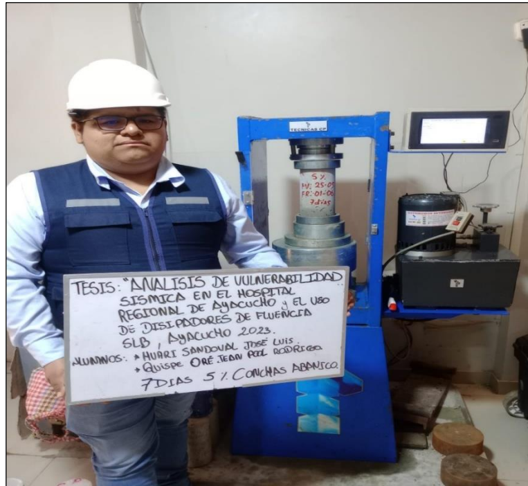
Foto 47. Ensayo de resistencia a la compresión de las probetas de concreto con adición de 5% de conchas de abanico a los 7 días de edad.
