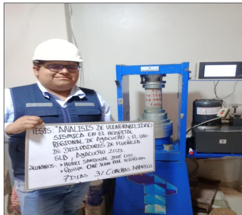
Foto 46. Ensayo de resistencia a la compresión de las probetas de concreto con adición de 3% de conchas de abanico a los 7 días de edad.
