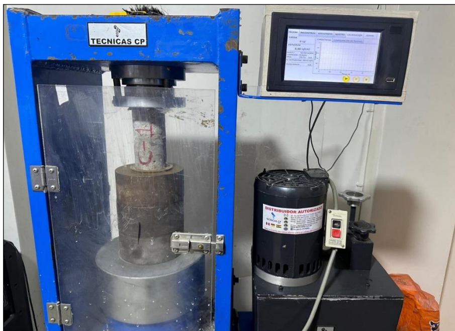
Foto 14. Realización de la resistencia a compresión (testigos de columna).
