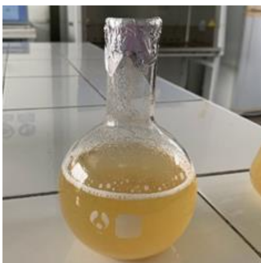
Fotografía 4. En la boquilla del matraz se colocó un pequeño papel de aluminio.
