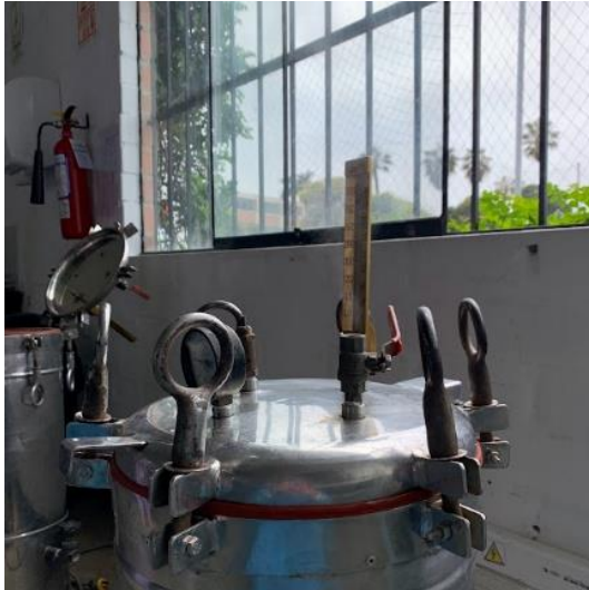
Fotografía 8. Antes de abrir la autoclave, la presión debe de llegar a 0° y dejar que enfríe.
