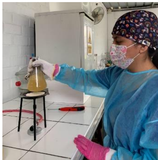
Fotografía 5. Se colocó el matraz sobre el mechero para lograr la homogenización del medio y su ebullición. Luego, se colocó nuevamente papel aluminio para sellarlo correctamente.
