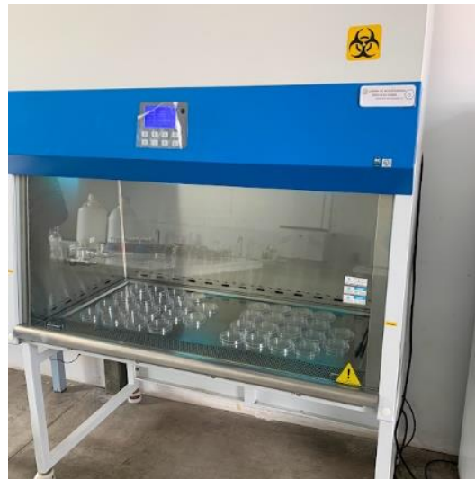
Fotografía 7. Se colocó la pipeta pasteur y placas petri (16) + 2 a esterilizar en la cabina de bioseguridad con la luz ultravioleta.
