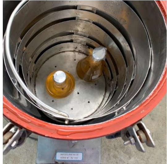
Fotografía 8. Antes de abrir la autoclave, la presión debe de llegar a 0° y dejar que enfríe.
