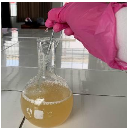
Fotografía 3. Mezcla con agua destilada (400 ml) calculado con ayuda de una probeta.
