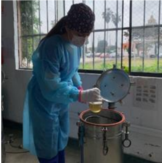
Fotografía 6. Se colocó el matraz dentro del autoclave
