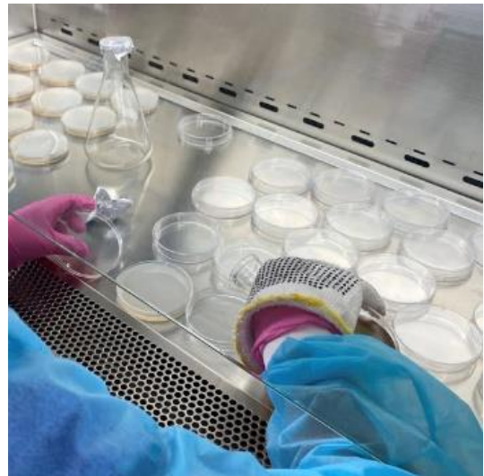
Fotografía 9. Destapar el sellado del matraz dentro de la cabina de bioseguridad, verter el preparado sobre las placas petri, cubriendo toda la superficie y tapar. Dejar 20 min, hasta que logre una consistencia gelatinosa.
