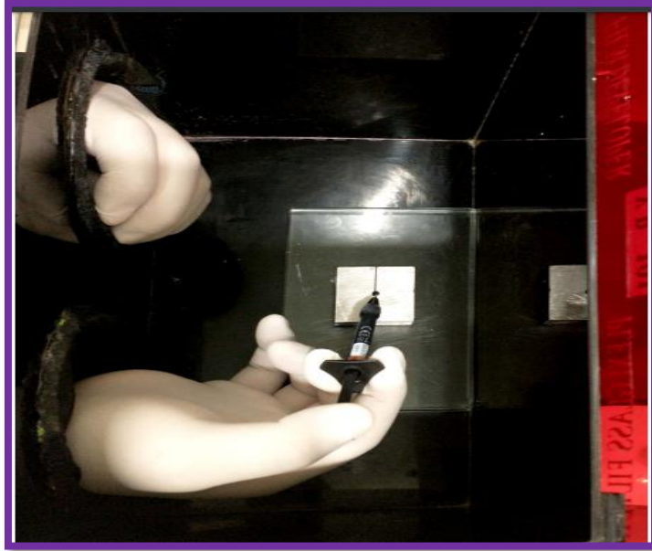
Figura N°5: Inyectando la resina en la matriz de acero inoxidable
