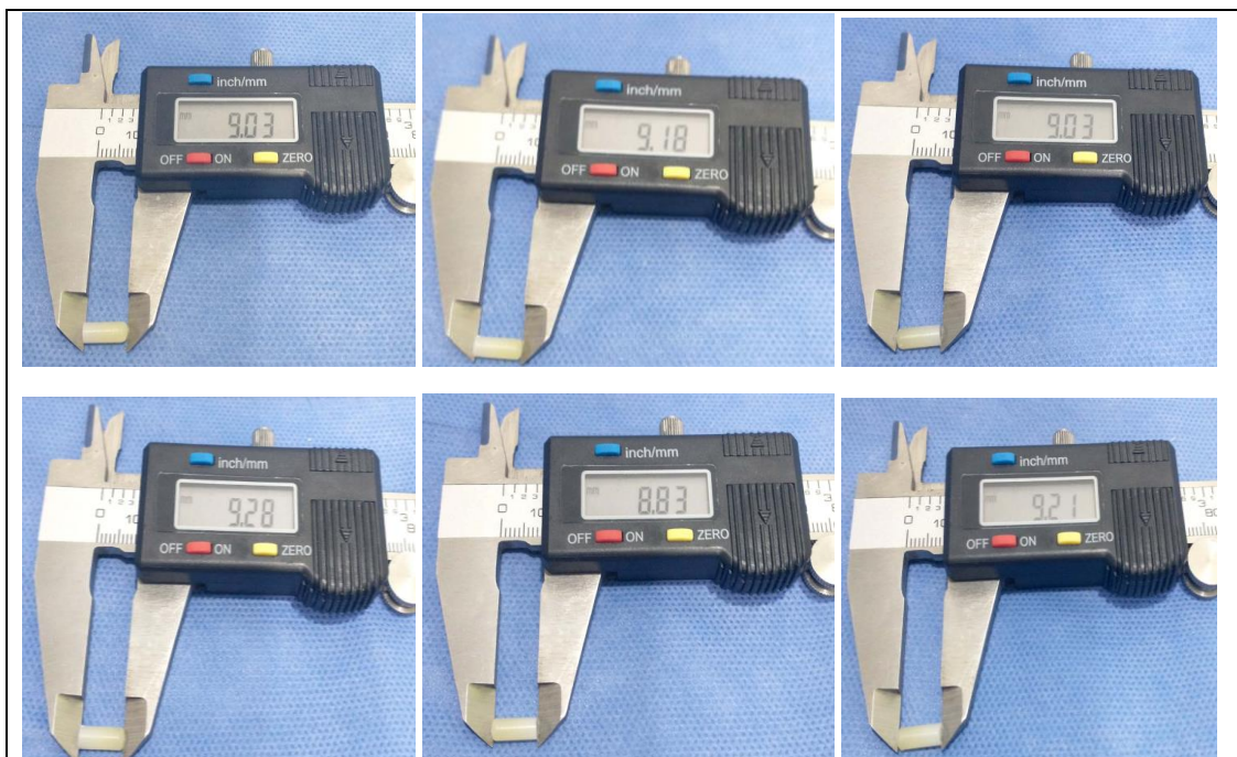
Figura N°8: Midiendo la longitud de las muestras fotopolimerizadas con la unidad de fotoactivación LED C PLUS de Woodpecker.
