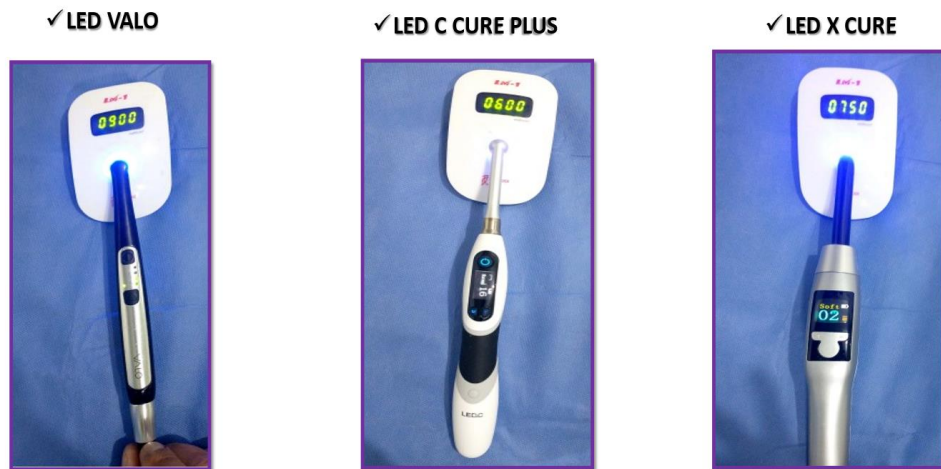
Figura N°3: Fotos de registro de la evaluación de la potencia de las tres unidades de la fotoactivación mediante el uso de un radiómetro de la marca Woodpecker
