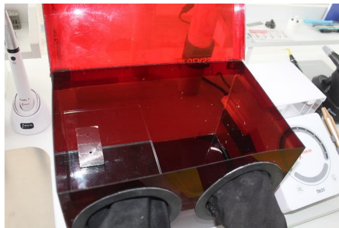
Figura N°4: Caja reveladora que contiene una platina de vidrio en su interior para dar mayor estabilidad a la matriz de acero inoxidable.
