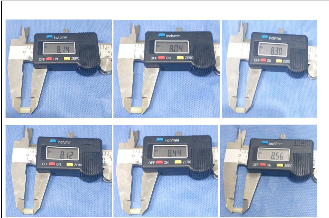
Figura N°8: Midiendo la longitud de las muestras fotopolimerizadas con la unidad de fotoactivación LED X-CURE de Woodpecker.
