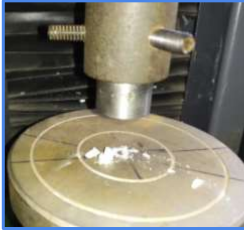
Fotografía 9. Registro de punto de fractura (Punto máximo valor de resistencia a la compresión de los cementos dentales)
