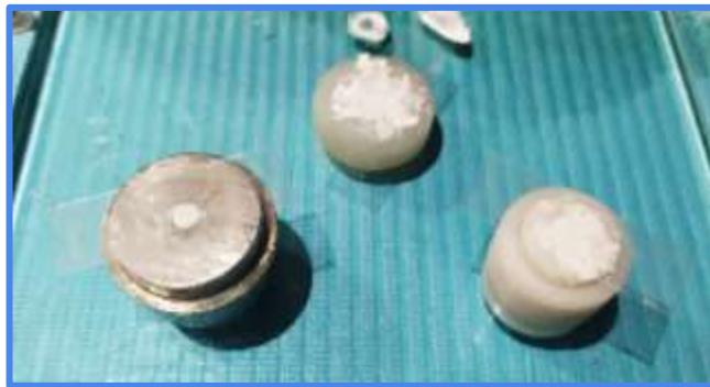
Fotografía 4. Elaboración de muestras por la técnica de monobloque por medio de la matriz de polietileno y matrices metálicas
