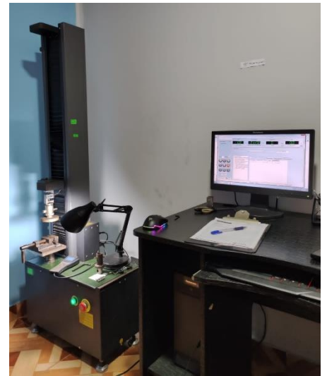
10.- Máquina Universal "LG CMT -5L" (para realizar la resistencia a la fractura).
