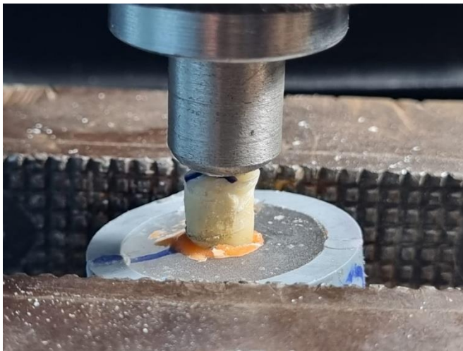
13.- Aplicación de fuerza compresiva utilizando la máquina Universal (LG CMT – 5L) en fuerza Newton.
