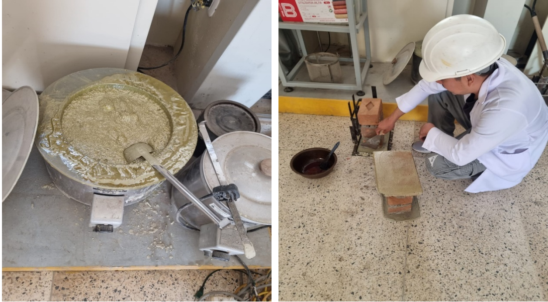
Preparación del capeado superior e inferior de las pilas de albañilería.
