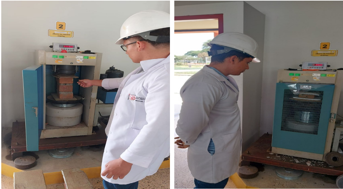
Acomodando correctamente las pilas para dar inicio al procedimiento de rotura de pilas de albañilería.
