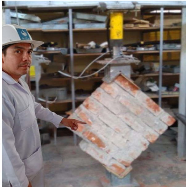
Colocación de los muretes de albañilería para proceder con el ensayo.
