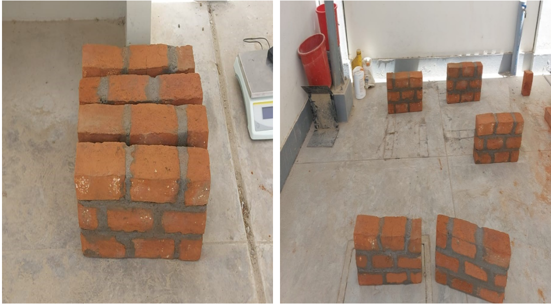
Proceso de secado de mortero en los muretes para alcanzar su máxima resistencia a la compresión.
