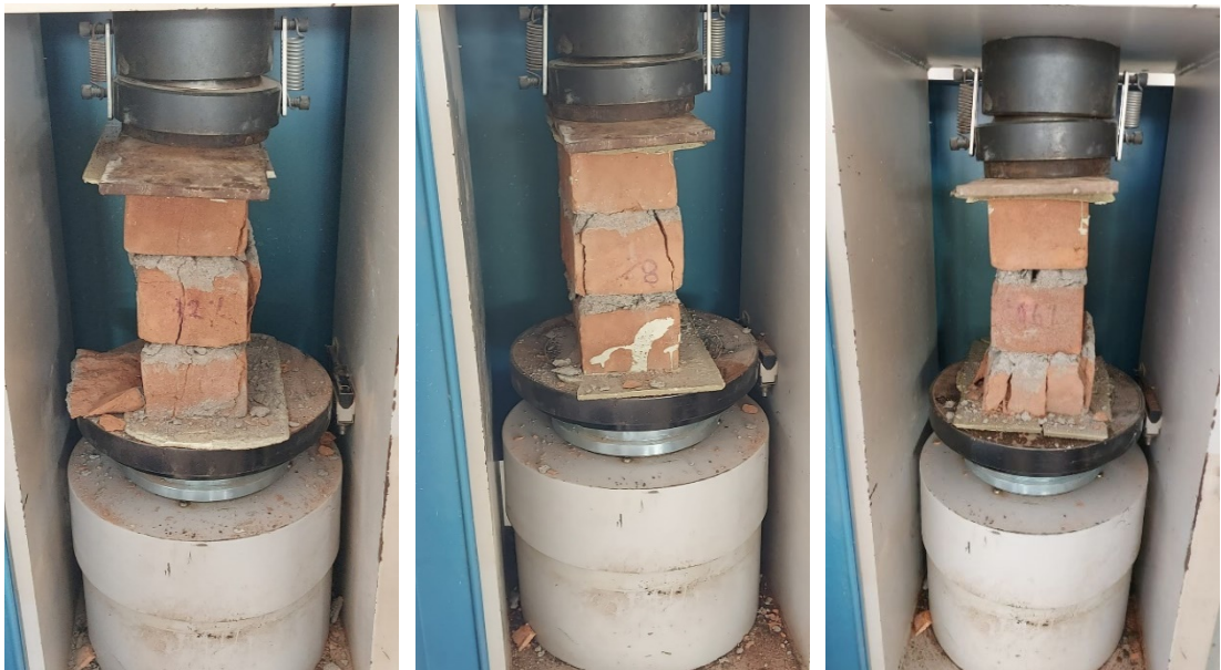
Rotura de las pilas de albañilería con cada porcentaje de estudio.
