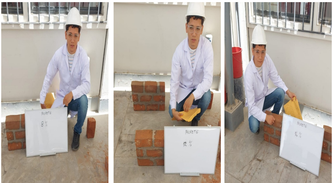
Muretes de albañilería listos para ser sometidos al ensayo de resistencia a la compresión
