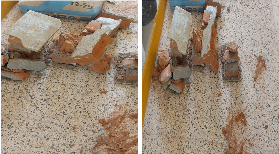
Resultado final de las pilas de albañilería sometidas a compresión.
