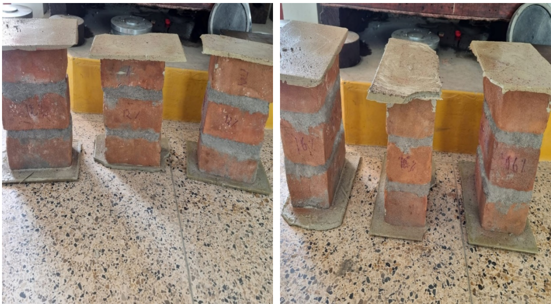
Muestras listas para el ensayo de rotura de pilas de albañilería.
